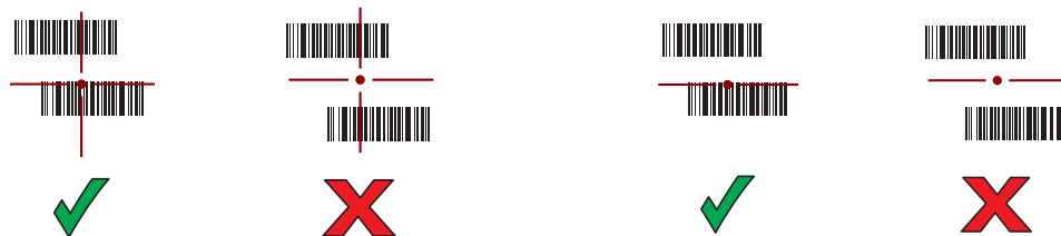
图 29 条码拣读模式，并且瞄准图案中有多个条码：标准和延伸范围
